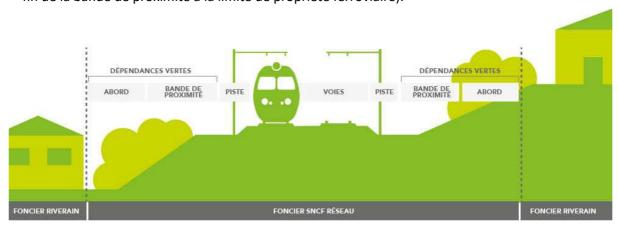
**Sur les voies et pistes**, SNCF Réseau effectue des opérations régulières (sauf exception, 1 à 2 fois par an) de désherbage à l'aide de produits phytopharmaceutiques. Elles sont principalement réalisées par des trains spécifiques appelés « trains désherbeurs » circulant jusqu'à 60 km/h.
